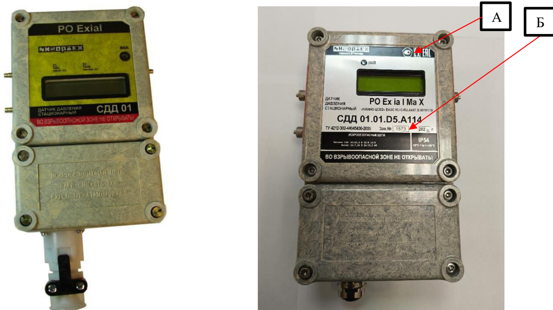
а) датчики со встроенными тензомодулями разности давлений и/или абсолютного давления/избыточного давления
