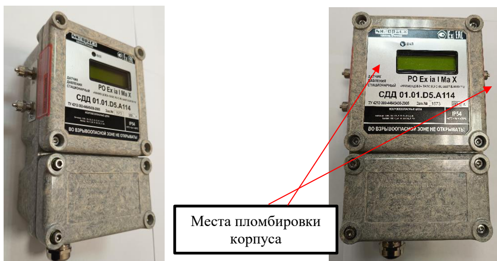
а) пример пломбировки торца корпуса
