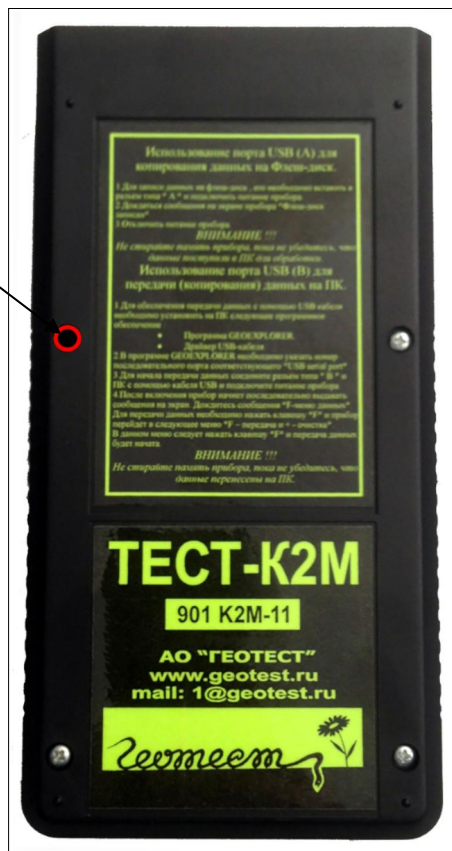
Рисунок 2 - Схема пломбировки от несанкционированного доступа
