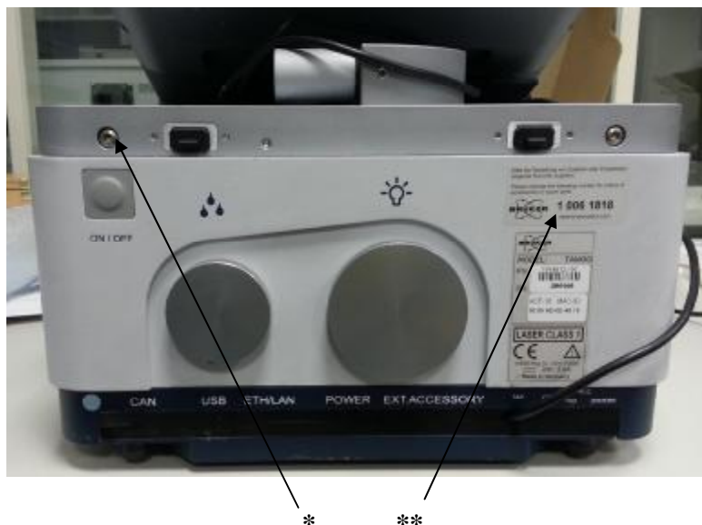
Рисунок 2 – задняя панель спектрометров TANGO-R, *- место пломбирования, ** - место маркировки
