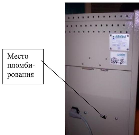
Рисунок 2 - Схема пломбирования приборов КиШ 20-2200
